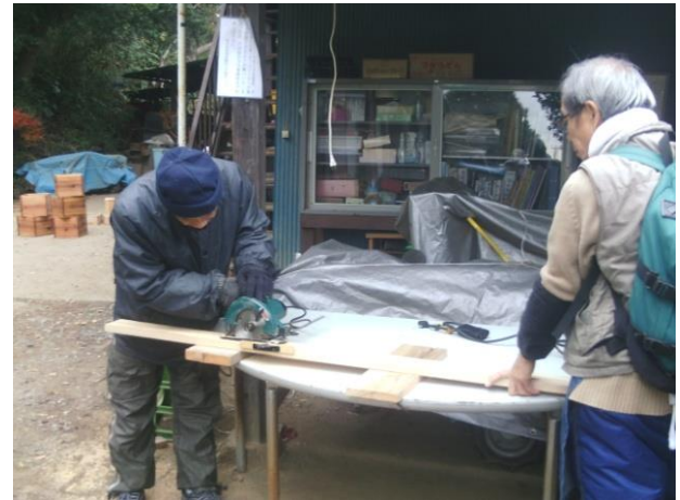
(説明： 丸鋸による縦割り )
